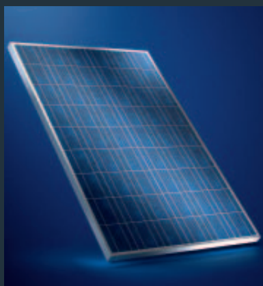
Schüco SPV 200-SPA-2 Maße: 1.493,6 x 999,6 x 44 mm Nennleistung ( P_{mpp} ): 200 W p
